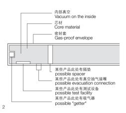
率)取决于隔热系统的几何外形、制作材料及边沿处所采用的成形和连接工艺。
