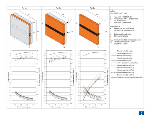
■ Wie ändern sich die Oberflächentemperaturen innen auf der ungestörten Fläche und im Bereich der Wärmebrücken?
